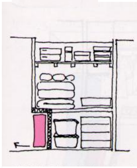
押入下部利用設置蓄熱暖房器
